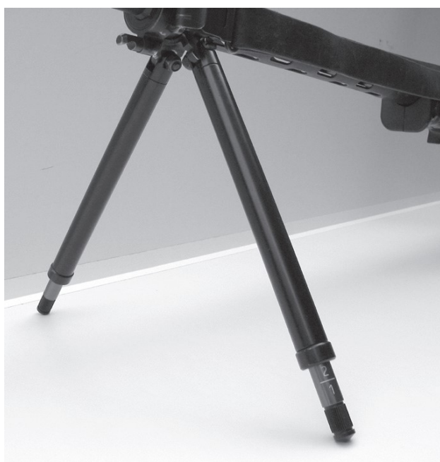
Figura 11: Bipiede regolabile per F ass 57, diversi modelli
