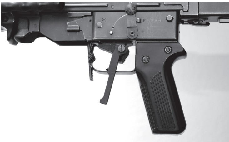
Bild 22: Winterabzug für Linksschützen zu Stgw 57
