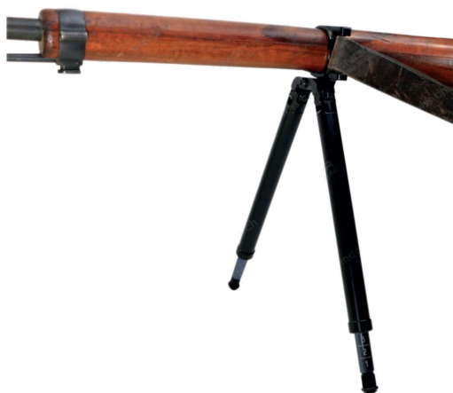
Figura 27: Bipiede regolabile Modello Wyss
