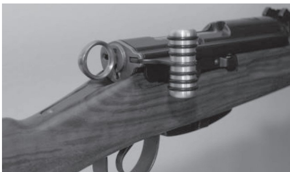
Bild 30: Riegelgriff anatomisch zu Karabiner und Langgewehr
