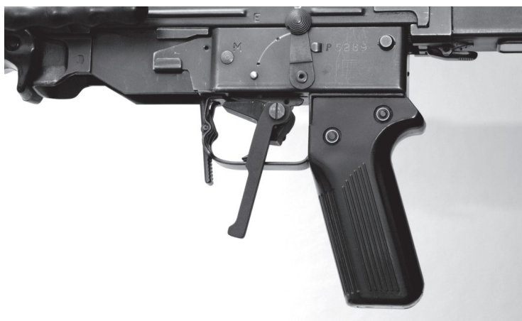
Figura 33: grilletto ausiliario d'inverno per F ass 57
