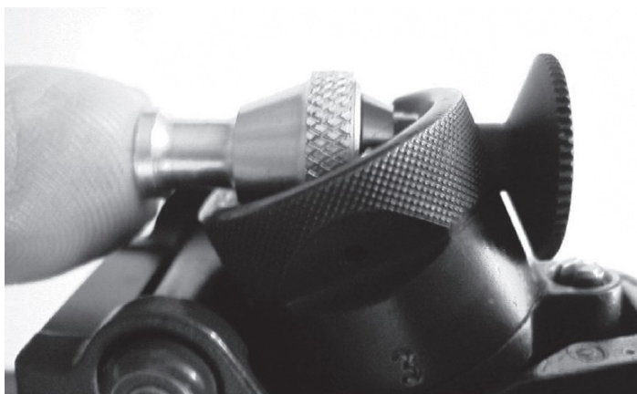
Figura 8: sistema di filtri colorati Wyss innestabile
