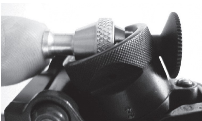
Bild 8: Farbfiltersystem Wyss, aufsteckbar
