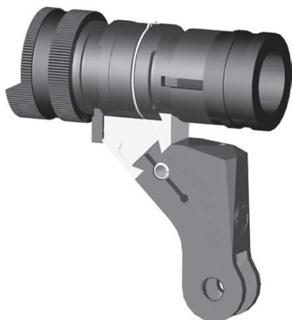
Bild 24: Universalkornträger zu Stgw 57 (Normalmontage), diverse Fabrikate
